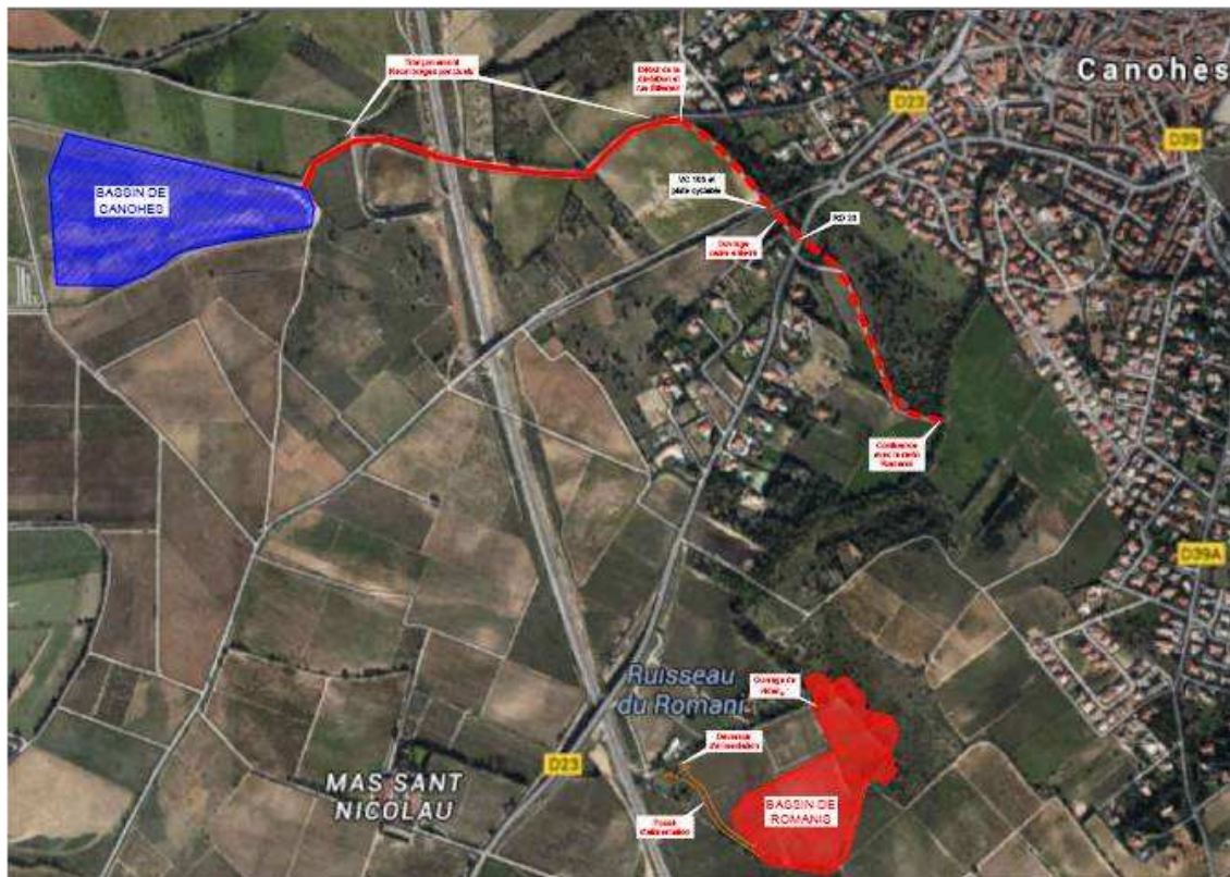
Figure 15 : plan des ouvrages de mise hors d'eau du village de CANOHES par l'agouille d'en Jassal et le ravin des Roumanis
