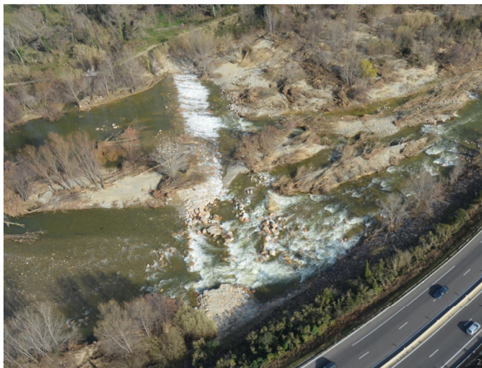
Déchaussement pile de pont de Millas
