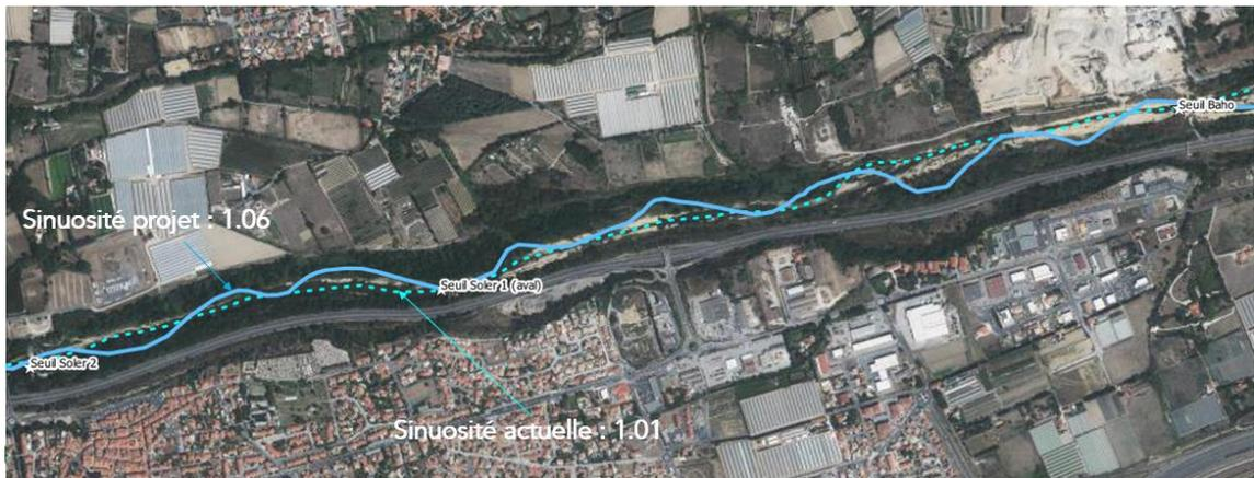
Figure 3-6. Comparaison de la sinuosité actuelle (1,01) à la sinuosité projet (1,06).
