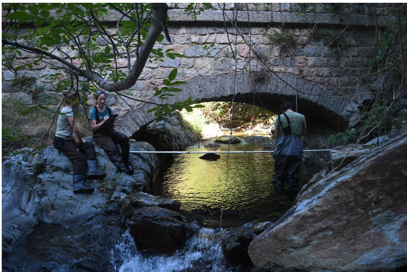
Figure 24 : Jaugeage au courantomètre à la station du pont de Betllans @David Morichon 2020
